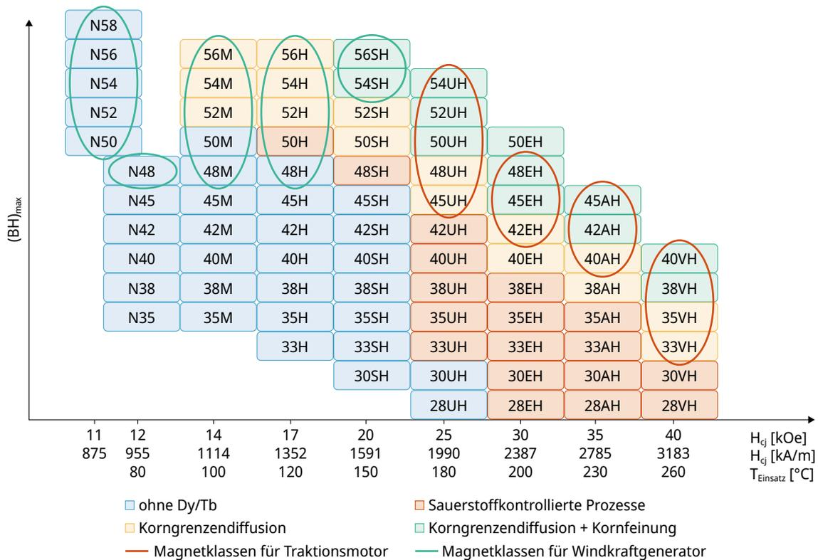
**Abb. 9: Kommerziell erhältliche NdFeB-Magnetklassen (engl. grades) mit Angabe typischer magnetischer Kenngrößen und Einsatztemperaturen. Eigene Darstellung nach FURGERI (2020), basierend auf dem chinesischen Standard GB/T 13560-2017 (2018). Die farbliche Unterteilung stellt die technische Entwicklung der NdFeB-Magnete dar, mit dem Ziel, immer bessere bzw. höhere Koerzitivfeldstärken zu erreichen und damit Anwendungen mit höheren Temperaturen, wie z.B. Traktionsmotoren, zu erschließen**
