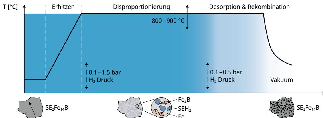
**Abb. 5: Prozessschema des HDDR-Verfahrens und resultierende polykristalline Mikrostruktur.**
