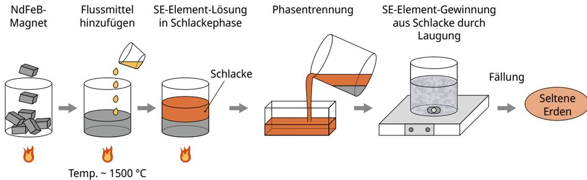
**Abb. 7: Beispiel eines pyrometallurgischen Recyclingverfahrens für NdFeB-Magnete. Eigene Darstellung nach KUMARI & SAHU (2023)**
