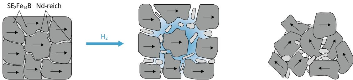
**Abb. 4: Schematische Darstellung der Funktionsweise der Wasserstoffversprödung.**
