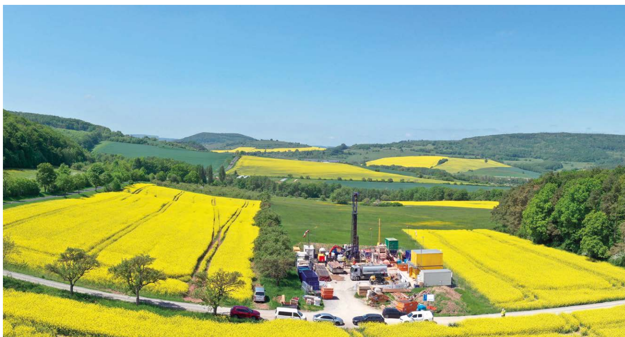
Abb. 7: Bohrung zur Erkundung des Kupferschiefers in Südthüringen, Foto: PerspektiveOben 3D Vermessung GmbH (mit frdl. Genehmigung).
