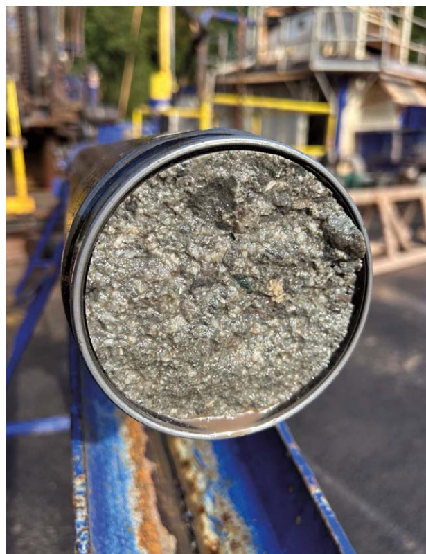
Abb. 6: Bohrkern des Grauliegenden unterhalb des Kupferschiefers in Südthüringen (Kerndurchmesser 10 cm), Foto: Anglo American Plc (mit frdl. Genehmigung).
