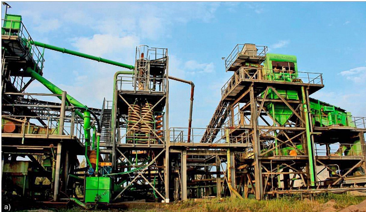
Abb. 3: Aufbau der Probenahme mittels Sortierspirale im Kieswerk 23/24 a) Anlage mit Leichtgut-Abscheidern und zusätzlich temporär eingebauter Schwergut-Sortierspirale (Fotos/Quelle wurden vom Betreiber der Lagerstätte zur Verfügung gestellt; in PERSCHL 2018)
