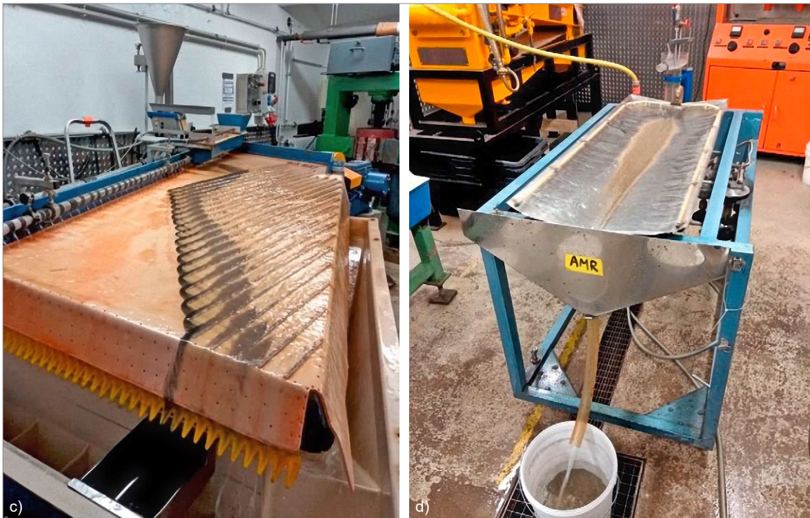
Abb. 7: Probenaufbereitung mittels Schütteltisch (c) und Mozley-Scheider (d) im Technikum des AMR (Fotos: PERSCHL 2018)
