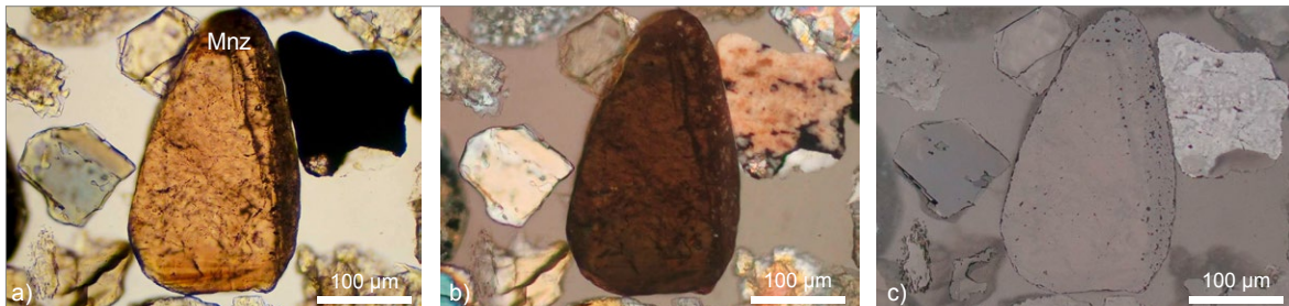
Abb. 87: Monazitpartikel (48C) in unterschiedlichen mikroskopischen Einstellungen, a) Durchlicht (HF-D), b) dito Auflicht (Nic-A), c) dito Auflicht (HL-A)
